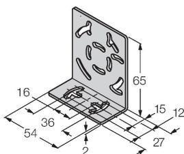
Монтажный кронштейн, нерж. сталь, для серии QS18, QS30, MINI-BEAM, QM42/QMT42
