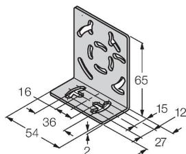
Монтажный кронштейн, нерж. сталь, для серии QS18, QS30, MINI-BEAM, QM42/QMT42
