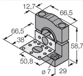
Монтажный кронштейн, ПБТ черный, с монтажной пластиной, нерж. сталь, для корпусов с резьбой 18 мм, QM42/QMT42
