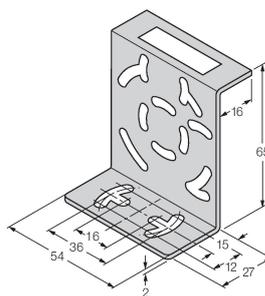
Монтажные зажимы, нерж. сталь, для серии QS18, QS30, MINI-BEAM, QM42/QMT42
