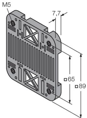
Монтажная плата для DIN-рейки подходит для CP80, DX80, K80, Q80, рабочая температура. -20... 90 °C
