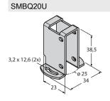
Защитный корпус, нерж. сталь, для серии Q20
