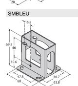
3086755 Защитный корпус, нерж. сталь, для датчиков серии LE250/550
