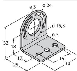
Монтажная скоба, угловая, металлическая, для рабочего освещения WLS28, просверленные отверстия 5 мм, набор винтов в комплекте
