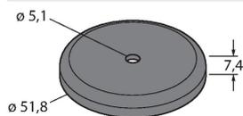
Магнитный монтажный кронштейн для установки фонарей рабочего освещения WLS28 на металлические поверхности
