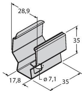
Накладной кронштейн для монтажа фонарей рабочего освещения WLS28
