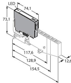
4 цифровых входа соотв. EN 60947-5-6. Для датчиков NAMUR, обесточенные контакты или 2-проводн. датчики DC uprox®+.
