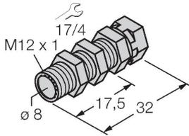
Зажим для быстрого монтажа со стопором; материал: хромированная латунь, внешняя резьба M12 x 1. прим.: Расстояние срабатывания датчиков приближения может сокращаться при использовании зажимов для быстрого монтажа.
