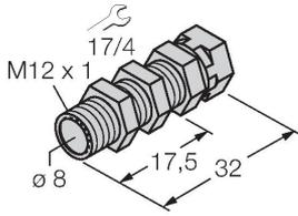
Зажим для быстрого монтажа со стопором; материал: хромированная латунь, внешняя резьба M12 x 1. прим.: Расстояние срабатывания датчиков приближения может сокращаться при использовании зажимов для быстрого монтажа.
