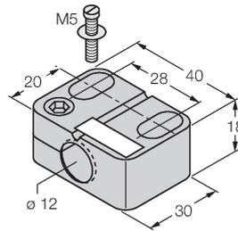
Монтажный зажим для цилиндрических резьбовых датчиков, с упором; материал: PA6
