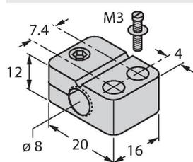
Монтажный зажим для цилиндрических резьбовых датчиков, с упором; материал: PA6
