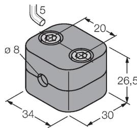
Монтажный зажим для цилиндрических гладких и резьбовых датчиков; материал: Полипропилен
