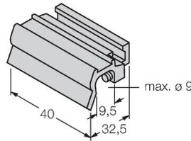
Аксессуары для монтажа датчиков BIM-INT и BIM-UNT на цилиндры с поршневым штоком; диаметр цилиндра: 50..63 мм; материал: Алюминий; другие монтажные принадлежности для цилиндров других диаметров по дополнительному заказу
