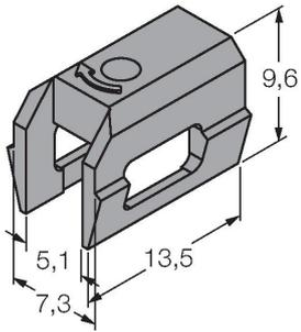
Монтажный кронштейн для установки датчиков магнитного поля на цилиндры с пазом типа "ласточкин хвост"; ширина паза: 7.35 мм; материал: PPS
