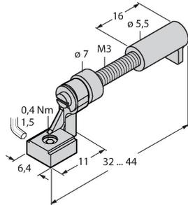
Аксессуары для тонкой настройки точки переключения на цилиндрах с Т-образным пазом; защелкивающийся монтаж датчика BIM-UNT; для многократного применения; материал: Металл/пластмасса
