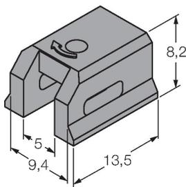
Монтажный кронштейн для установки датчиков магнитного поля на цилиндры с пазом типа "ласточкин хвост"; ширина паза: 9,4 мм; материал: PPS
