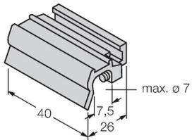
Аксессуары для монтажа датчиков BIM-INT и BIM-UNT на цилиндры с поршневым штоком; диаметр цилиндра: 32...40 мм; материал: Алюминий; другие монтажные принадлежности для цилиндров других диаметров по дополнительному заказу
