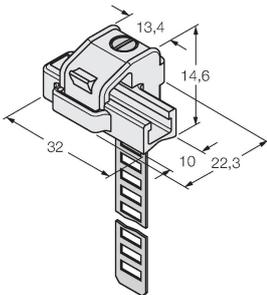
Монтажный кронштейн для установки датчиков магнитного поля на круглые цилиндры; диаметр цилиндра: 63...130 мм; материал: PA 6I/6T / мельхиор; классификация воспламеняемости в соотв. с UL94 - V2
