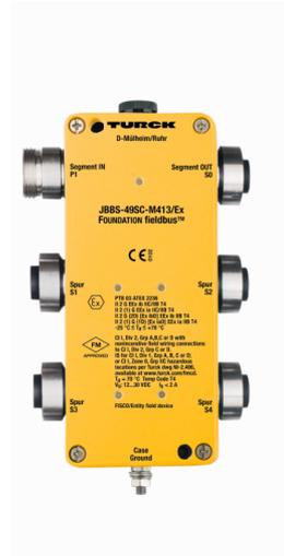
4-канальная взрывозащищенная распределительная коробка JBBS-49SC-M413/EX разработана для систем FOUNDATION™ fieldbus.
