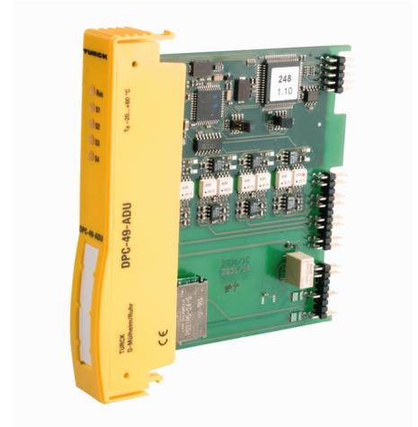
Система DPC (концентратор питания с функцией диагностики) является системой питания сегментов H1 шины FOUNDATION™. DPC обеспечивает широкие диагностические возможности для мониторинга состояния сегментов шины FOUNDATION™ и может быть интегрирована в автоматизированную систему управления предприятием (АСУП).
