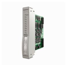
Модуль ввода/вывода DM80Ex используется для подключения датчиков NAMUR (DIN EN 60 60947-5-6) и исполнительных механизмов. При активном мониторинге обрыве и КЗ, механические контакты могут быть подключены через соответствующий резистор (WM1, идент. №. 0912101).
