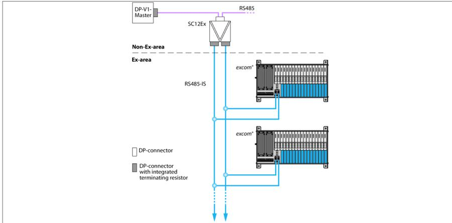
Коммутатор TURCK SC12Ex сегмента сети PROFIBUS-DP предназначен для подключения системы excom® со стороны искробезопасной сети PROFIBUS (интерфейс RS485-IS) к мастер-контроллеру (host системе), находящемуся со стороны неискробезопасной сети PROFIBUS (интерфейс RS485).
