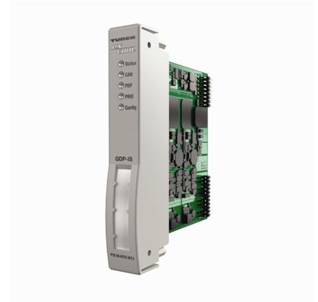
Шлюз GDP-IS служит для подключения excom® для сетей PROFIBUS-DP. Подключение к PROFIBUS-DP может быть организовано через оптоволоконный или медный кабель. При использовании оптоволоконной для передачи данных коммутационная пара должна быть встроена между медной линией и оптоволоконным подключением к PROFIBUS, которая также адаптирует уровень к IS слою. При использовании медных кабелей коммутатор сегмента (RS485-IS коммутатор) должен быть установлен с обеспечением условий взрывозащиты.
