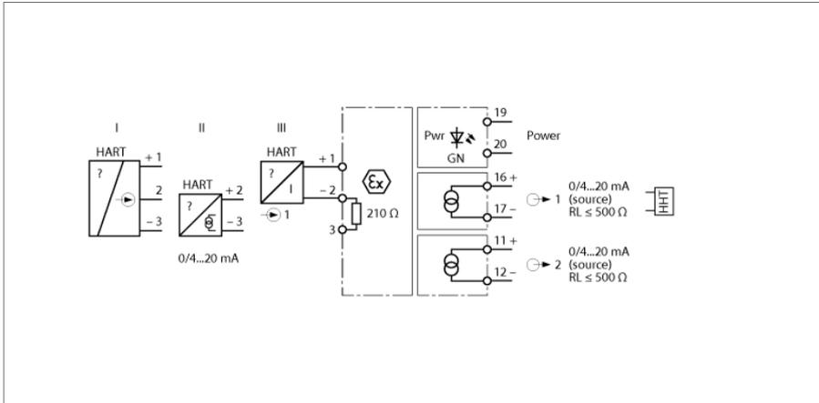
Одноканальный HART® изолирующий преобразователь IM33-12EX-HI служит для подключения искробезопасных HART® 2-х проводных преобразователей (III) во взрывоопасной зоне и передачи измеряемого сигнала в безопасную. В дополнение к аналоговым сигналам, преобразователь также передаёт цифровые сигналы HART® связи в обоих направлениях.
