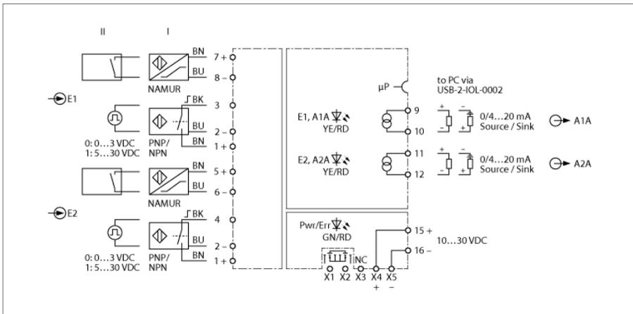
Преобразователь частоты/счетчик импульсов IM12-FI01-2SF-2I-CPR/24VDC/CC передает электрически изолированные частотные сигналы до 20 000 Гц. Дополнительно может осуществляться контроль проскальзывания входных сигналов. Допускается установка этих устройств в зоне 2.
