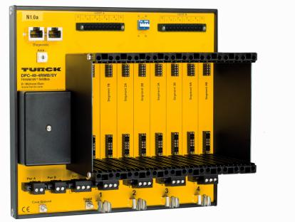
DPC sistemi (Tanısal Güç Şartlandırıcı), FOUNDATION™ fieldbus H1 bölümlerinin kuruşunu için bir güç kaynağı sistemiidir. FOUNDATION™ fieldbus bölümlerinin izlenmesi için geniş tanısal seçenekler sağlar ve böylelikle tesis genelinde varlık yönetimini destekler.
