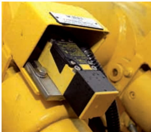
Die ATEX-zertifizierten Namur-Sensoren von Turck müssen im Meer Wind und Wetter trotzen
