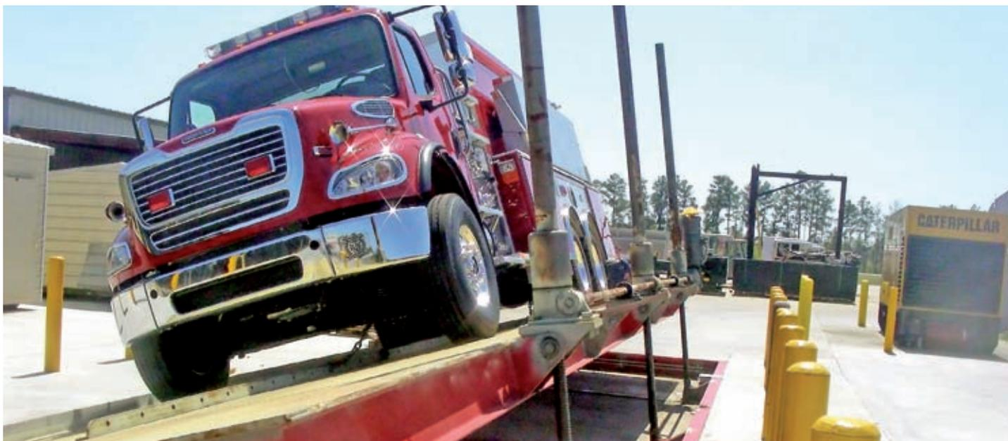
**Das tonnenschwere Einsatzfahrzeug muss auf dem Kipptisch bis zu einem Winkel von 26,5 Grad geneigt werden**
