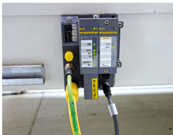
Turcks BL67-Gateway bringt die Daten über Profinet zur Siemens-SPS
