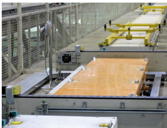
Die Karosserieteile auf der Schiene werden später vom UHF-Schreiblesekopf sicher erkannt
