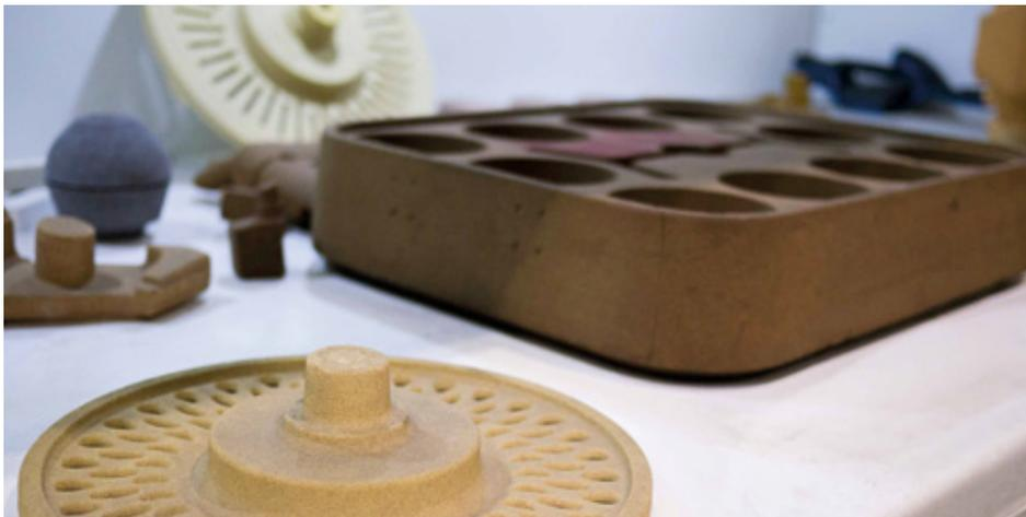
In den Kernschießmaschinen von Laempe Mössner Sinto werden unterschiedlichste Sandkerne für Metallguss hergestellt
