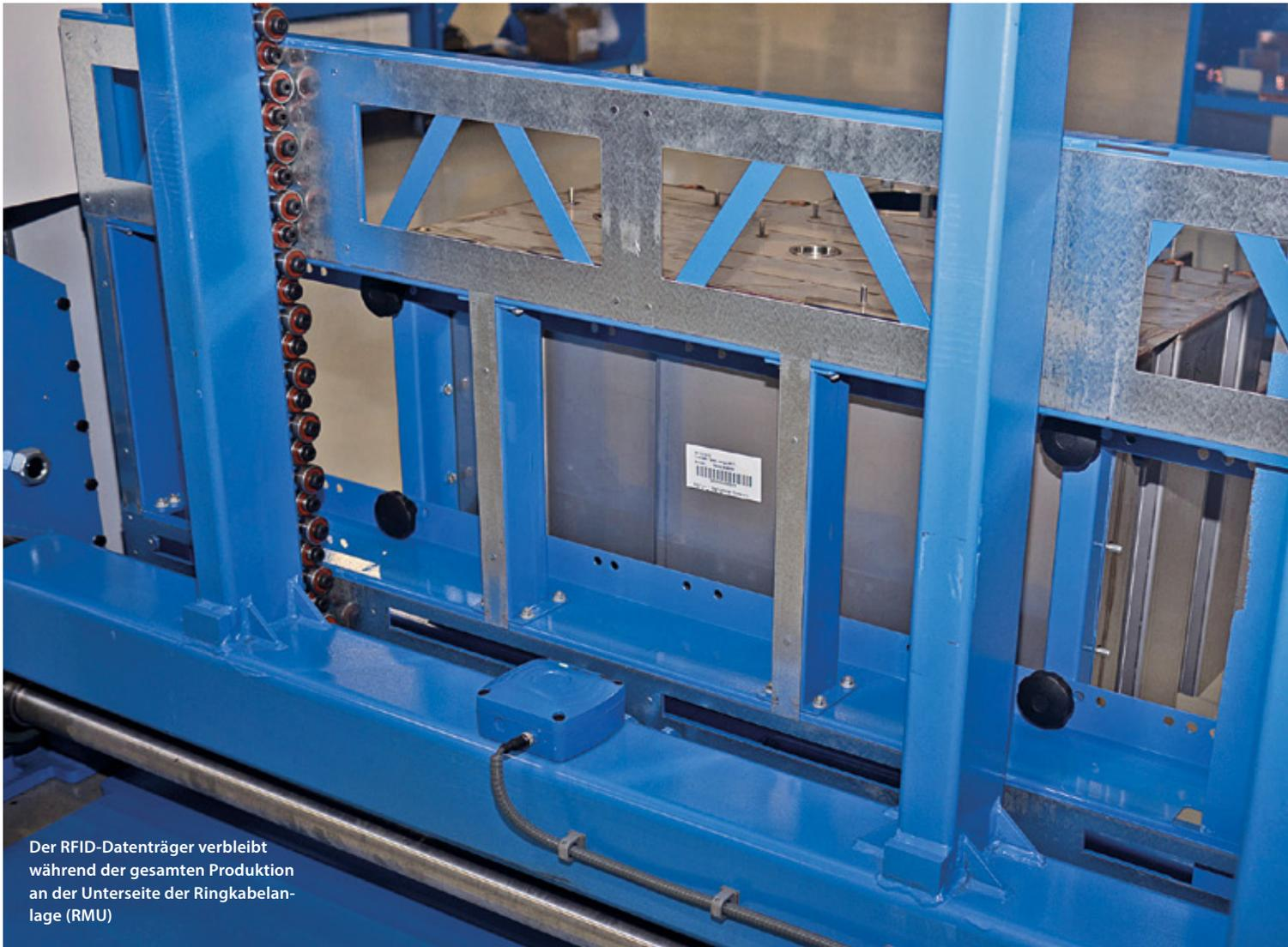
Der RFID-Datenträger verbleibt während der gesamten Produktion an der Unterseite der Ringkabelanlage (RMU)
