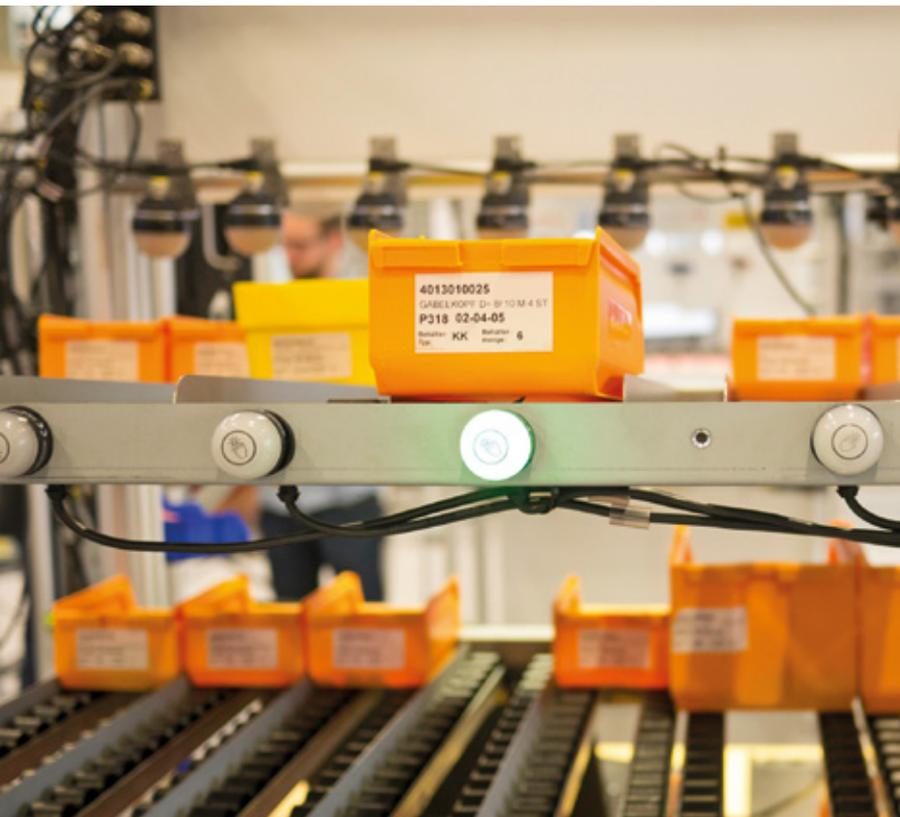
Das Put-to-Light-System zeigt an, in welche Reihe der frisch gefüllte Behälter eingeschoben werden muss
