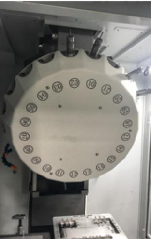
Werkzeugrevolver mit Schneidwerkzeugen
