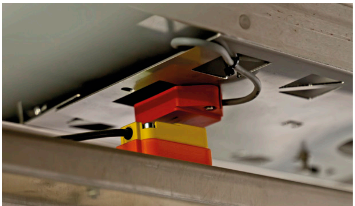
Am RFID-Datenträger ist ein Sensor-Element angeschlossen, das die Temperatur im Inneren des Lagerbehälters misst
