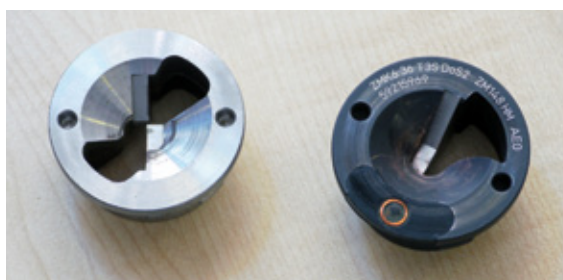
Der kompakte Datenträger konnte gut geschützt im Fräskopf (rechts) eingelassen werden
