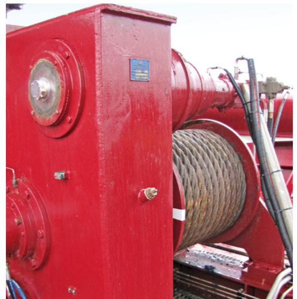
Drei dieser Winden richten das Saugrohr des Hopperbaggers aus, die Drehung der Welle erfasst der QR24
