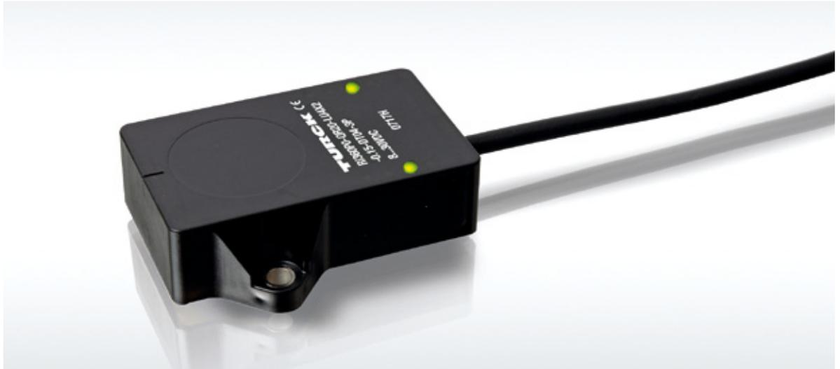
in einem kompakten und auf den Mobile-Equipment-Markt angepassten Gehäuse mit den Maßen 71 x 64 x 20 mm aufgebaut. Der Clou dabei: Das Gehäuse umschließt den Positionsgeber vollständig und deckt diesen somit nach außen hin vollständig ab. Eine zylindrische Aussparung im quaderförmigen Gehäuse bietet ausreichend Platz für den Positionsgeber – ohne eine mechanische Verbindung mit ihm einzugehen.
