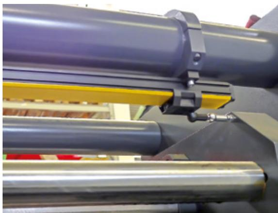
Vibrationen oder Schocks von bis zu 200 g widersteht der Sensor und gibt dabei durchgehend präzise Messwerte aus
