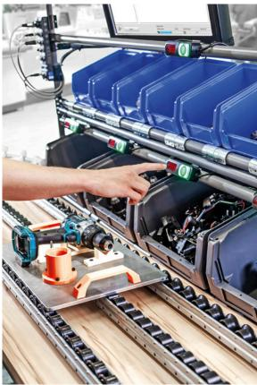
Die einfache Installation des automatisierten und modularen Pick-by-Light-Systems "Smart Light Touch" ist marktweit einzigartig – für den Aufbau wird nicht einmal ein Schraubendreher benötigt
