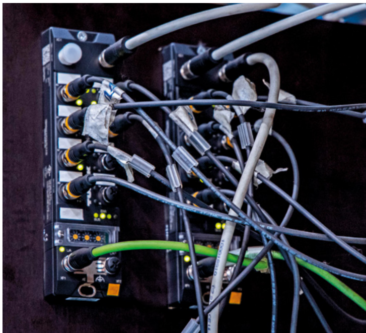
Die kompakten Block-I/O-Module TBEN-LL-16DXP führt die Sensordaten zusammen und übertragen sie in Echtzeit
