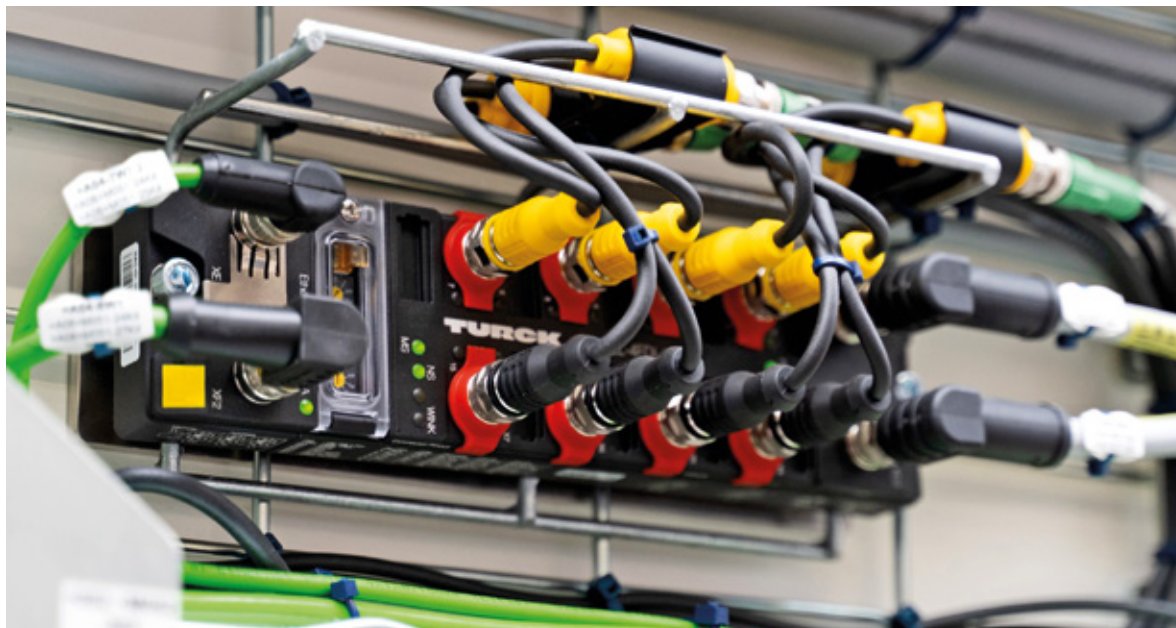
TURCKs konsequente Multiprotokoll-Strategie zahlt sich auch im Bereich der Sicherheitstechnik aus, hier das Safety-Modul TBIP für EtherNet/IP und CIP-Safety
