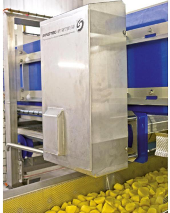
**Doppelte Sicherheit: Die Edelstahlhaube deckt den gesamten Motor samt Drehgeber im Betrieb ab**
