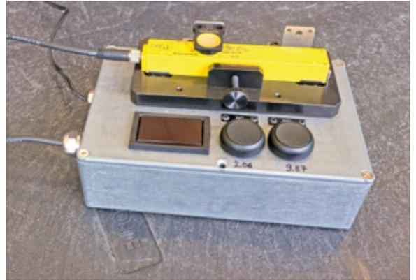
Mit dieser selbstgebauten Vorrichtung teachen die Precitrame-Mitarbeiter die Li-Sensoren per Knopfdruck auf den benötigten Erfassungsbereich von 55 Millimetern
