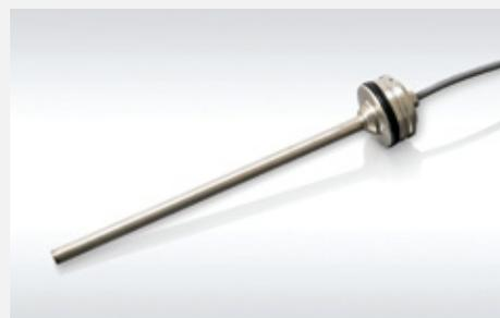
Turck ergänzt das Portfolio seiner Linearwegsensoren um den robusten LTE zur direkten Integration in Hydraulikzylinder. Der magnetostruktive Sensor widersteht Schocks bis zu 100 g und Vibrationen, wie sie bei Agrar- oder Forstmaschinen alltäglich sind. Das Gerät ist zudem unempfindlich gegenüber äußeren Einflüssen, sodass der LTE selbst für den Einsatz in Hydraulikzylindern von Baumaschinen in besonders rauen Umgebungen geeignet ist.
