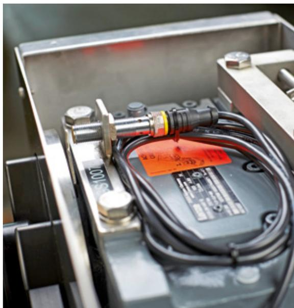
Über die Schaltfahne erkennt der IO-Link-Sensor BI6U-M12-IOL6X2 die korrekte Stellung der Dreheinheit
