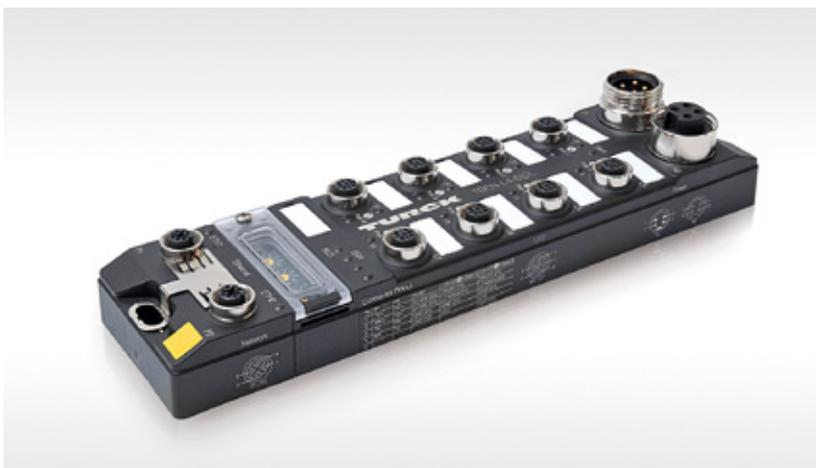
Die TBEN-IO-Link-Master mit „Simple IO-Link-Device Integration“ (SIDI) haben heute schon die Möglichkeit, Turck- und Banner-Geräte per Plug-&-Play zu integrieren
