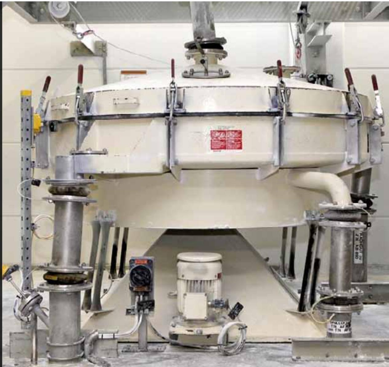
WACKER hat am Standort Burghausen mehrere Taumelsiebe mit Turcks RFID-Lösung für den Staub-Ex-Bereich ausgerüstet
